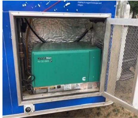
Generador instalado en el compartimento exterior de la unidad
